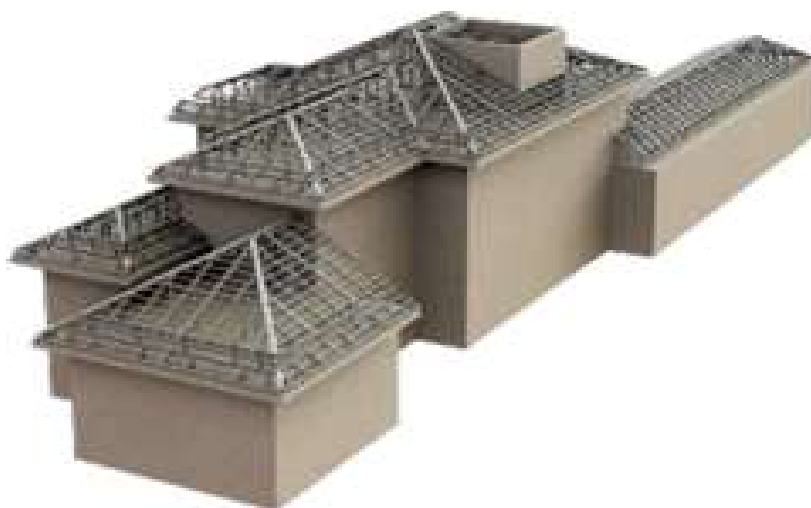
Figura 20 – Estrutura de cobertura em LSF
